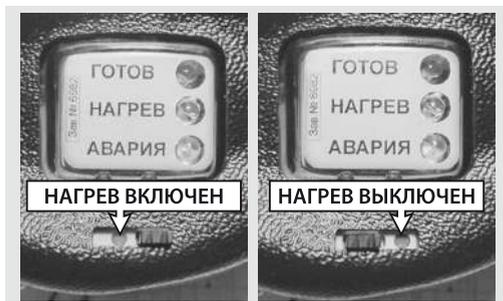
Данное устройство оборудовано выключателем нагрева воды:
