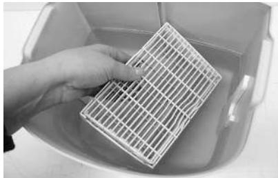
Поставьте фильтр на ровную поверхность, под небольшим углом, на 30 минут, и подождите пока стечет вода.
