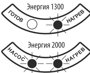
Выставить температуру, включить в розетку с заземлением, загорится индикация:
